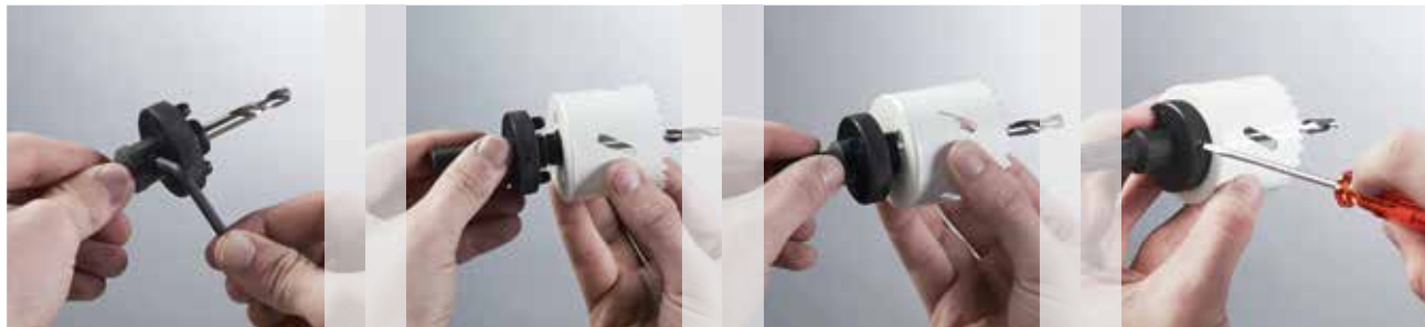
Установка центрирующего сверла. Крепление винтом с внутренним шестигранником.
