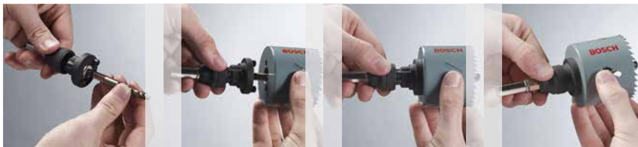
Установка центрирующего сверла
